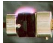
沿面放電試験
