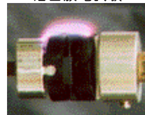
沿面放電試験
