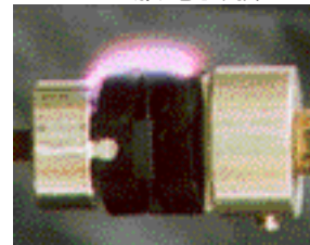
沿面放電試験
