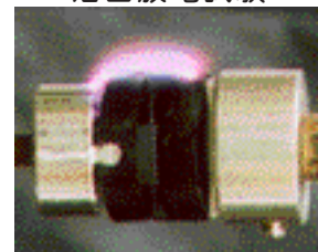
沿面放電試験
