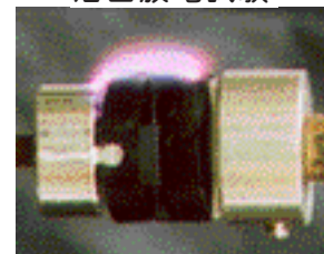
沿面放電試験
