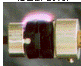
沿面放電試験
