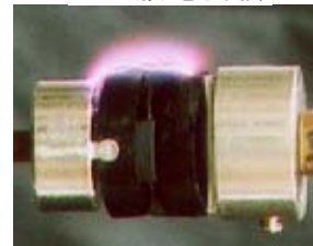
沿面放電試験
