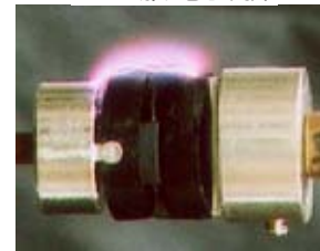
沿面放電試験
