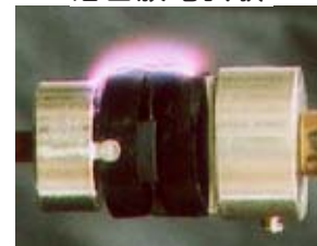
沿面放電試験
