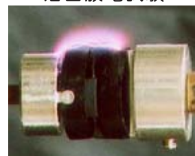
沿面放電試験
