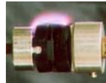
沿面放電試験
