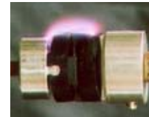
沿面放電試験
