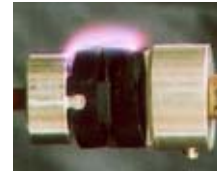
沿面放電試験
