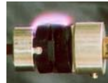
沿面放電試験
