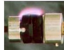
沿面放電試験
