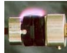
沿面放電試験
