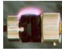
沿面放電試験
