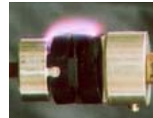
沿面放電試験
