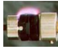
沿面放電試験
