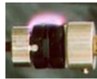
沿面放電試験
