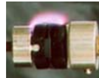
沿面放電試験
