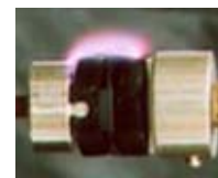
沿面放電試験
