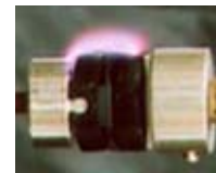
沿面放電試験
