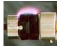
沿面放電試験
