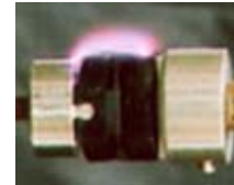
沿面放電試験
