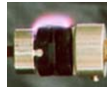
沿面放電試験
