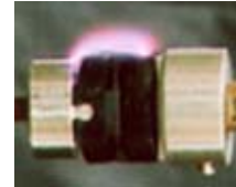
沿面放電試験
