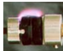
沿面放電試験
