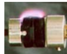
沿面放電試験
