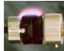
沿面放電試験
