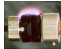
沿面放電試験
