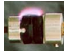
沿面放電試験
