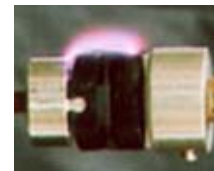
沿面放電試験
