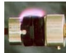
沿面放電試験
