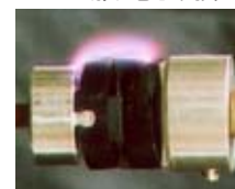
沿面放電試験
