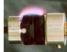
沿面放電試験
