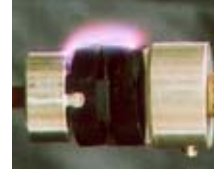
沿面放電試験
