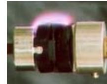
沿面放電試験
