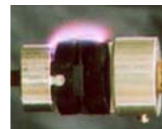
沿面放電試験
