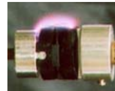
沿面放電試験
