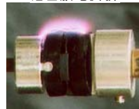
沿面放電試験
