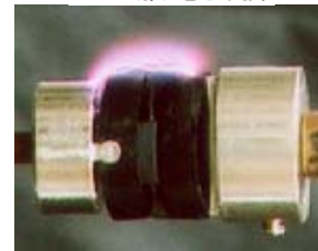
沿面放電試験
