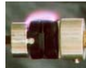
沿面放電試験
