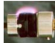
沿面放電試験
