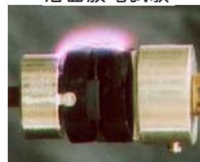
沿面放電試験
