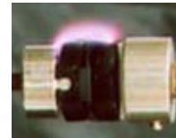
沿面放電試験
