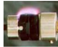
沿面放電試験
