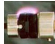
沿面放電試験
