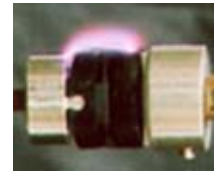
沿面放電試験
