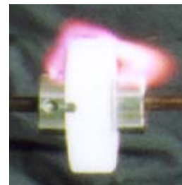
沿面放電試験
